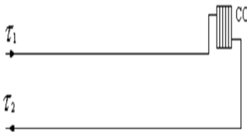
Рисунок 20/1 – Схема присоединения теплопотребляющих установок потребителей к тепловым сетям
